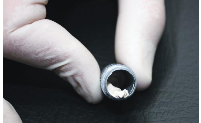
Figuur 2 De putty-achtige consistentie van Biodentine nadat het poeder en de vloeistof 30 seconden mechanisch zijn gemengd.
